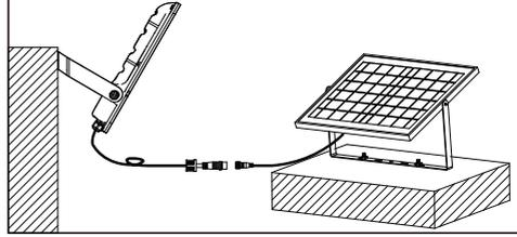
**Bước 3.** Kết nối dây giữa tấm pin năng lượng mặt trời và đèn LED pha lại với nhau như hình bên dưới.
