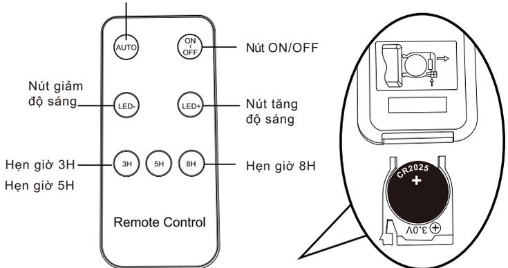
Bộ điều khiển từ xa (remote) sử dụng pin CR2025
