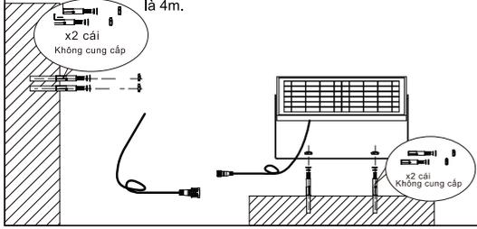
**Bước 2.** Điều chỉnh tấm pin và đèn pha đúng hướng mong muốn.
